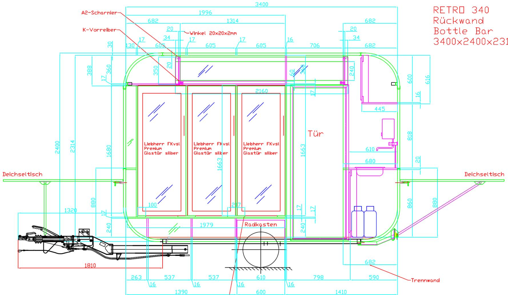
Kühlschrankbefestigung unten mit Winkel 25x25x3mm
